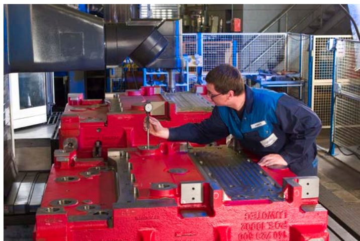
Es kommt auf Hundertstel Millimeter an. Ein Mitarbeiter kontrolliert den Fertigungsprozess an der Fräsmaschine ANAYAK HVM 5000.
