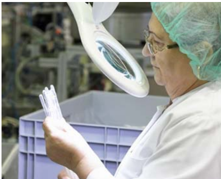
Qualitätskontrolle der Magensonden während der Produktion
