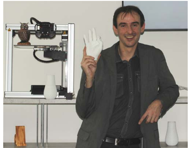
Seine eigene Hand in Kunststoff-Filament verewigen. Alexander Petto zeigt das eindrucksvolle Druckergebnis, hergestellt mit dem Drucker Felix 3.1 im Hintergrund.
